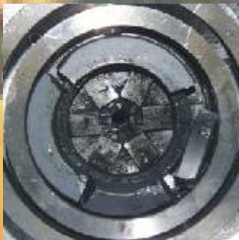
katastrophales Versagen von unbeschichteten SiC-Gleitlagern im Trockenlauf
