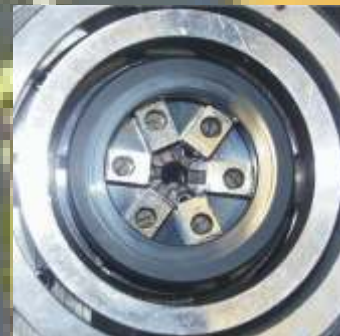
diamantbeschichtete SiC-Gleitlager nach 20000m Trockenlauf, die Oberfläche ist lediglich poliert
